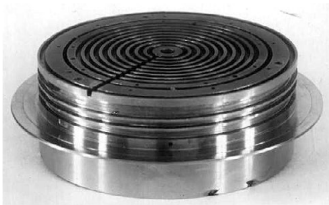
Измерительная ячейка метода плоского слоя, выполненная из титана ВТ4
