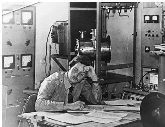
Борис Немзер проводит измерения поверхностного натяжения нефтяных фракций на созданной им экспериментальной установке
