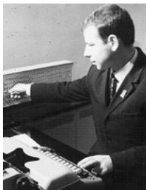
Студент А.А. ГЕРАСИМОВ проводит измерения теплоемкости на проточной калориметрической установке
